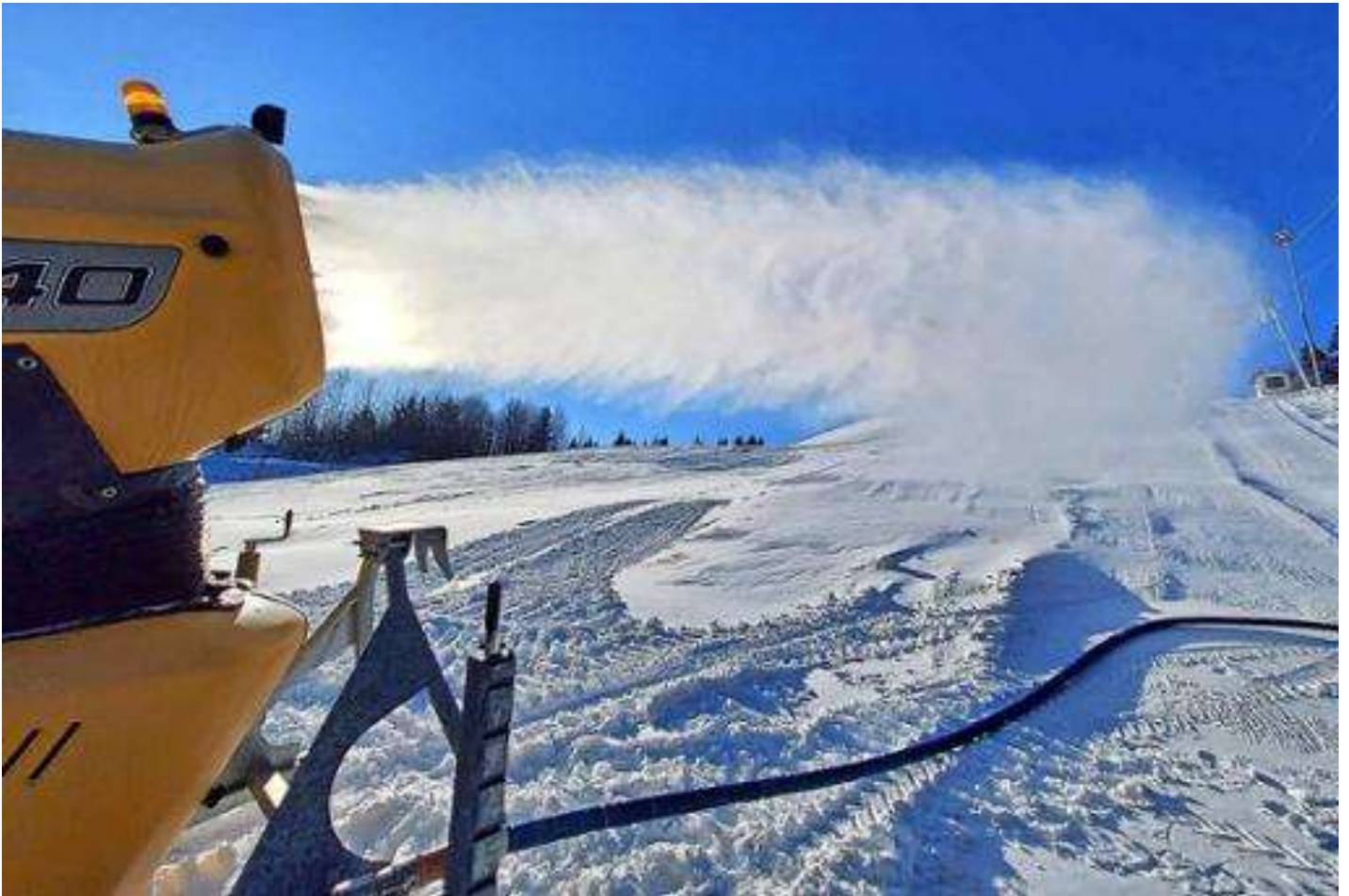
Die Schneekanone bläst den Kompaktschnee mit 25 Bar auf die Piste. Der Pistenbully versch Fotos: Sebastian Wolf
